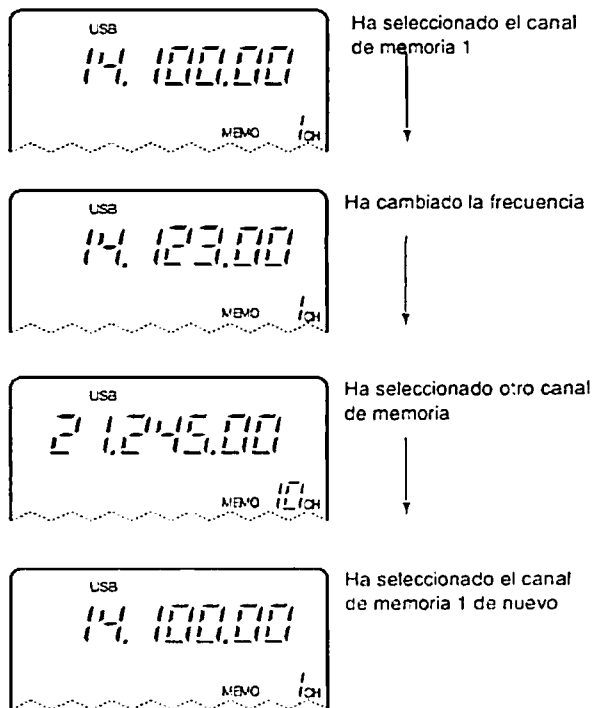
No aparece la frecuencia cambiada (14.123 MHz) y en cambio aparece la frecuencia memorizada (14.100 MHz)
