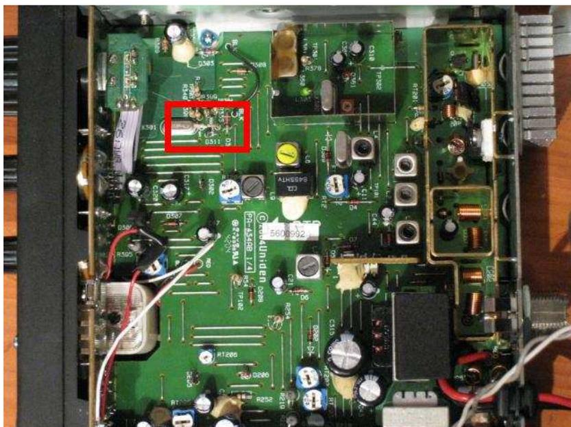
4\_ El cable debería de quedar así, si queréis volver a cerrar el equipo solo tenéis que empalmar el cable o colocar uno nuevo.
