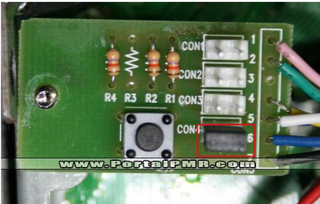
6. En la imagen anterior hemos señalado un componente, este **componente deberá ser cambiado a la posición justo por encima suya**. Para realizar el cambio lo sujetaremos con unas pinzas y lo retiraremos con mucho cuidado.
