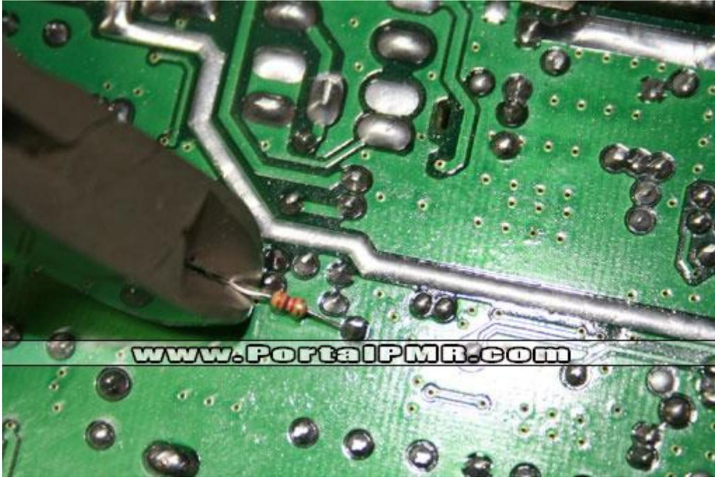
5. Nosotros hemos preferido **cortar solo una "patilla" y envolver la resistencia con cinta aislante**, pero cada uno puede realizar la modificación como crea pertinente.
